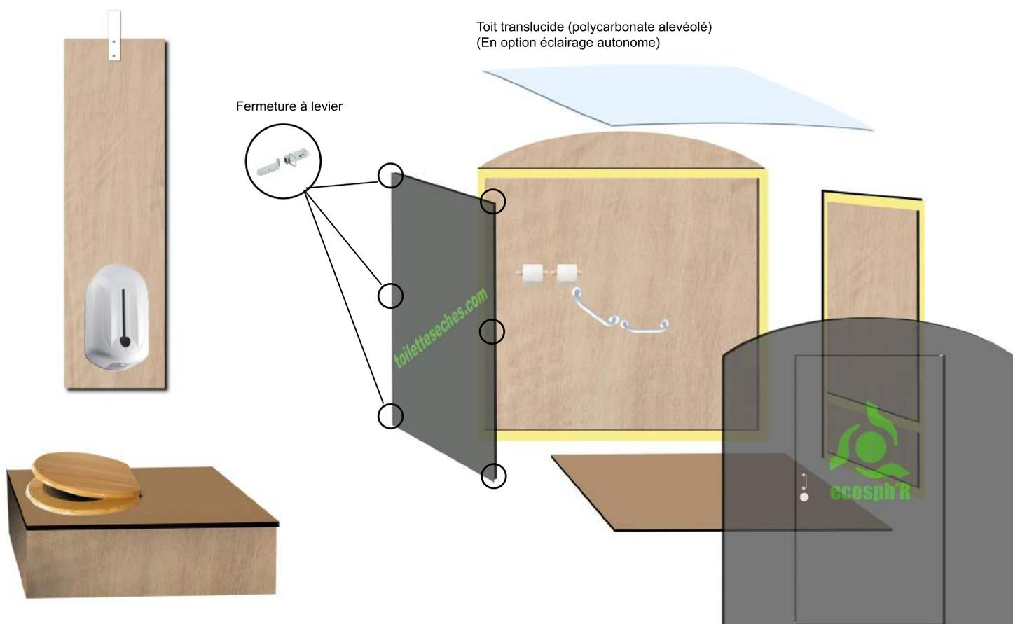
Poids total : 200 Kgs / Encombrement au sol : 2.25m<sup>2</sup> / Volume total : 4,5m<sup>3</sup> / Montage : 30 min / 2 personnes sans outils
